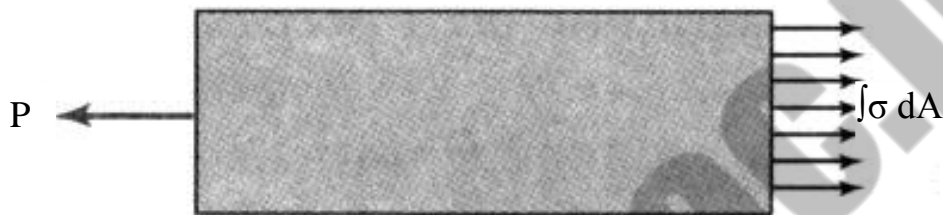
شکل ۱-۱: تصویر جسم آزاد میله تحت نیروی خارجی P.
