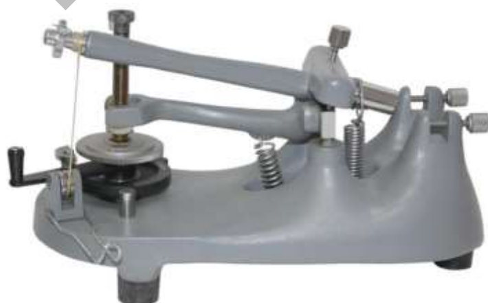
شکل ۲-۲۶ میکروتوم راکینگ کمبریج (۱۲)
