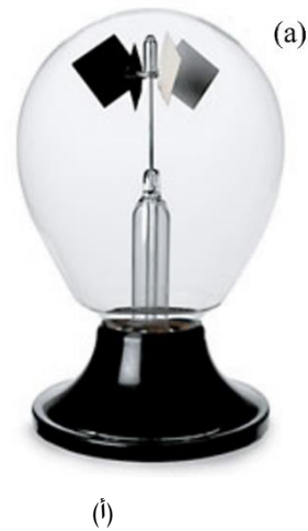
شکل ۴-۱۹ ا. رادیومتر کروک ب. سرعت دورانی اندازه‌گیری‌شده آن
