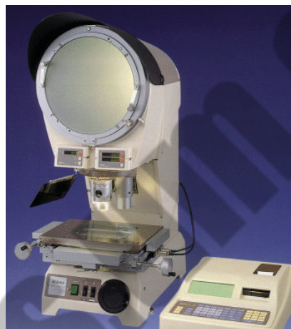
شکل ۱-۲: دستگاه سایه نگار نیکون برای اندازه‌گیری ابعاد محوری و شکل اجسام
